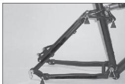
Broj zglobova možete jednostavno prebrojiti. Spoj prema opružnom elementu ne broji se kao zglob.
