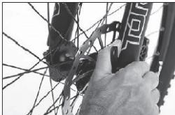
2. Okrećite navojnu maticu u smjeru suprotnom od kazaljke na satu dok se kotač ne može izvaditi iz okvira odnosno prednje vilice bez uporabe velike sile. Ako potpuno uklonite maticu iz vijka, pazite da se male opruge ne izgube.
