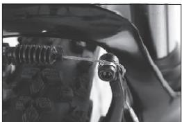
2. Provjerite je li čitav sustav za kočenje ispravno pričvršćen i jesu li navojni spojevi u redu:
