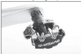
Kod SPD pedala su obuća i pedala u vertikalnom smjeru čvrsto povezane. Tako se tijekom vožnje pedale ne samo mogu pritisnati prema dolje, nego i vući prema gore. Za korištenje SPD pedala potrebna je specijalna obuća prilagođena pojedinom sustavu pedala na koju se pričvršćuje kukica pedale priložena određenoj pedali.
